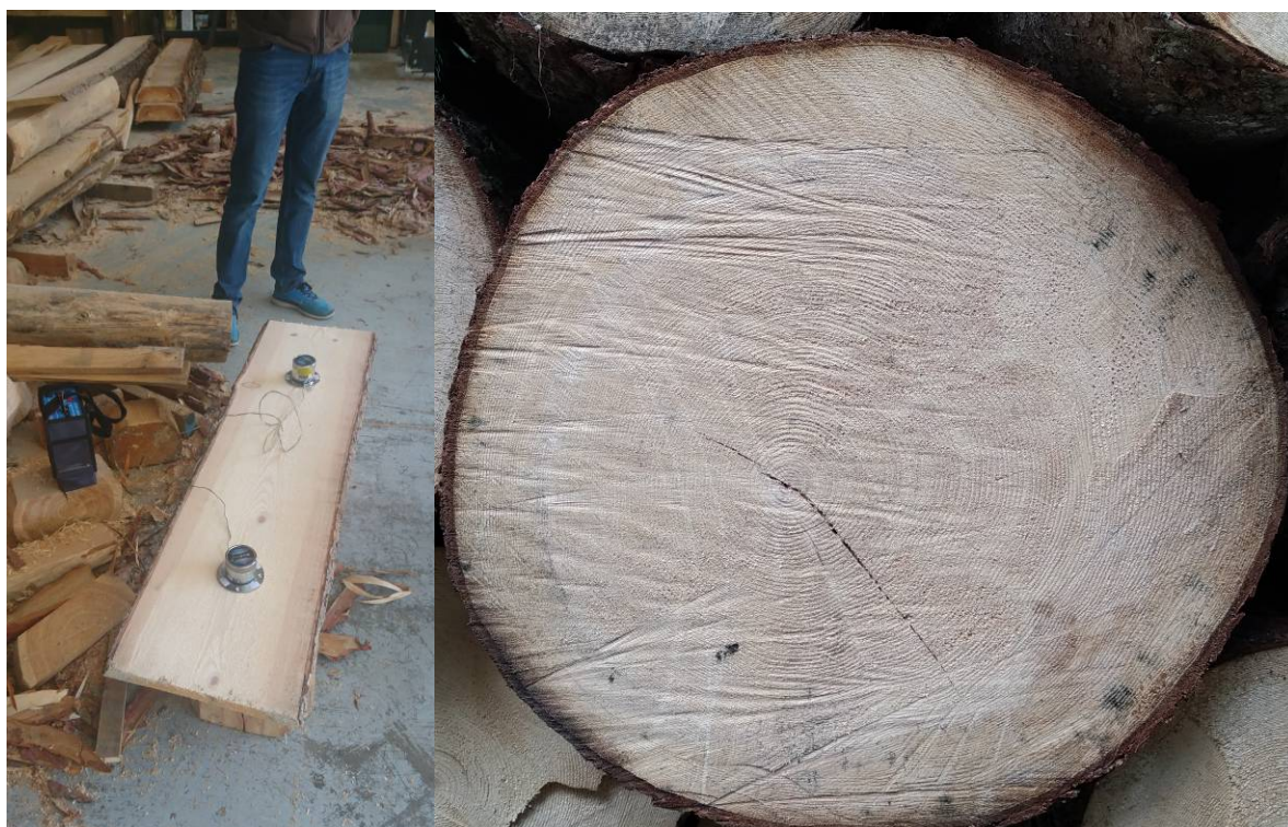
Fig. 66 - Prime verifiche dell'armonicità di tavole ricavate da legni abbattuti dalla tempesta Vaia (2019)
